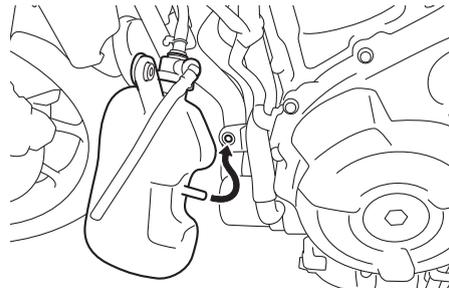
8. Retirer la vis de vidange du liquide de refroidissement et son joint afin de vider le circuit de refroidissement.
