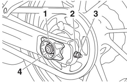
1. Excentrique de réglage de la tension de la chaîne de transmission
