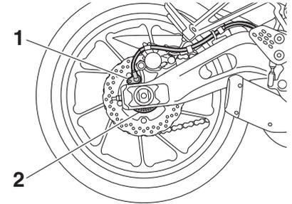
1. Capteur de roue arrière
