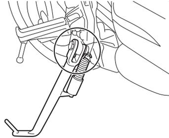
Contrôler le fonctionnement de la béquille latérale avant chaque départ et lubrifier son articulation et les points de contact des surfaces métalliques quand nécessaire.
