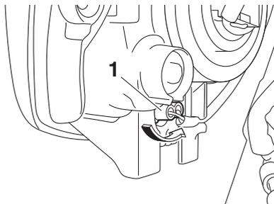
1. Douille d'ampoule de veilleuse
