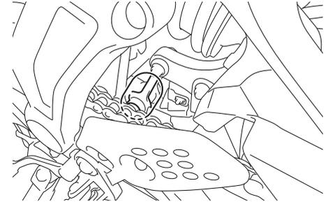
Faire lubrifier les articulations de la suspension arrière par un concessionnaire Yamaha aux fréquences spécifiées dans le tableau des entretiens et graissages périodiques.
