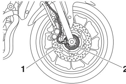
1. Capteur de roue avant
