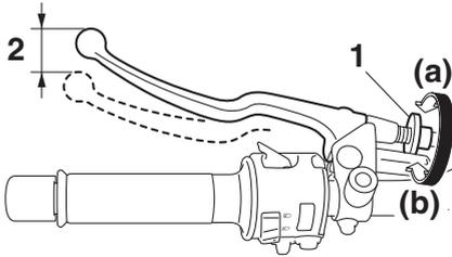
1. Vis de réglage de la garde du levier d'embrayage
