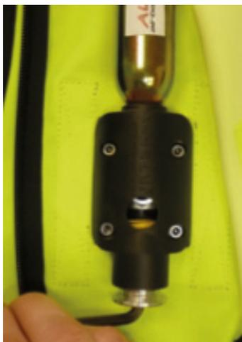
B - Commencez par dévisser le bouchon avec la clé Allen fournie. Dévissez suffisamment pour que le percuteur puisse redescendre au niveau du passage pour la clé-bille.
